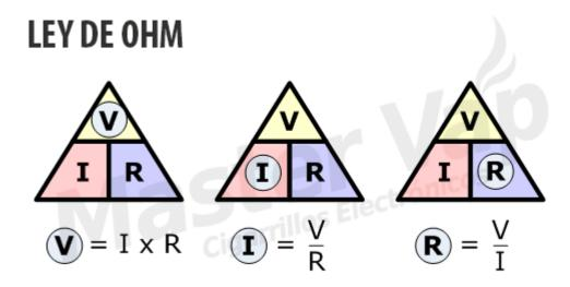
En esta imagen podemos observar una representación de la Ley de Ohm que nos permite identificar cuáles son los elementos que la componen, utilizando este esquema del triángulo podemos identificar cuando los factores se dividen o se multiplican.
