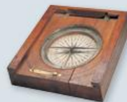
Brújula: instrumento de origen chino introducido y perfeccionado en Europa hacia el siglo XIV. Permitía, a través de una aguja imantada, señalar el norte y, con ello, los otros puntos cardinales.
