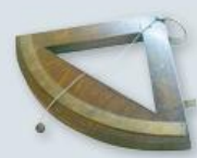
Cuadrante: instrumento que permitía determinar la latitud y calcular la hora (midiendo la altura del sol).
