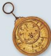
Astrolabio: antiguo instrumento que permitía calcular la latitud de un lugar, y por tanto, la ubicación de las embarcaciones. Introducido hacia el siglo XII por los árabes en Europa occidental donde se perfecciona.
